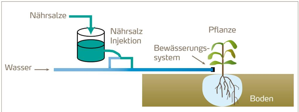
Eine Tropfanlage besteht aus einer Kopfstation (Ventilgruppe) mit Absperrhähnen der Düngereinspeisung, einem Magnetventil und einem Be- und Entlüftungsventil. Von der Kopfstation geht ein Verteilrohr ab. An dieser Querverteilung sind mehreren Abgänge an denen die eigentlichen Tropfleitungen angebracht sind. Mehrere Tropfrohre sind am Ende mit einer Spülleitung und Spülventil zusammengefasst (sinnvoll zur Wartung des Systems).
