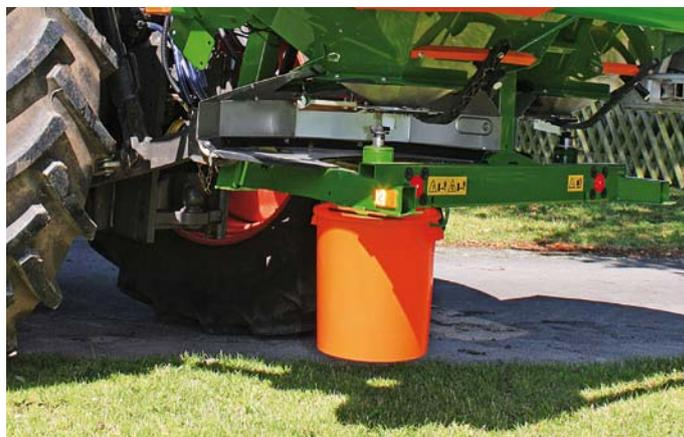
Kontrolle der Stromenge mittels Abdrehtprobe
