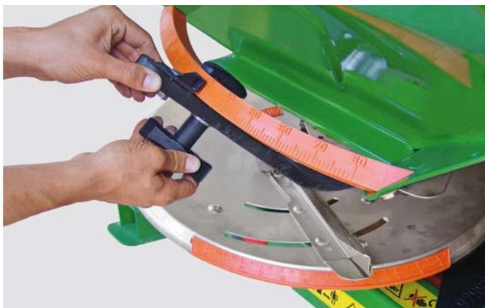
Einstellung der Stromenge mittels Dosierschieber
