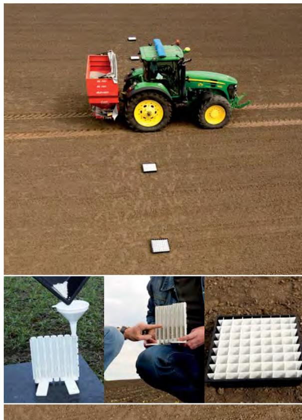
Abb. 2: Streuschalen-Set zur Überprüfung der Düngerstreuer-Einstellung
